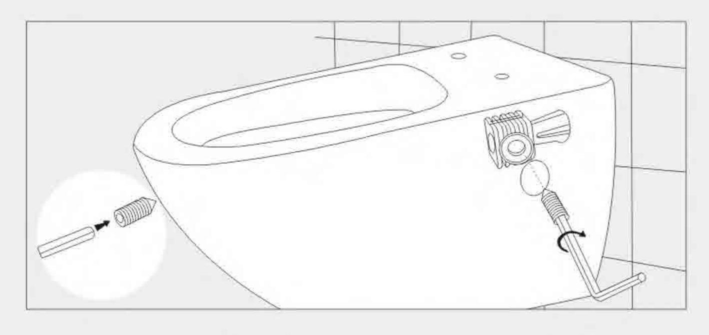
• 5. 把D旋入C的螺丝孔上,用A来使其固定在安装孔上!
