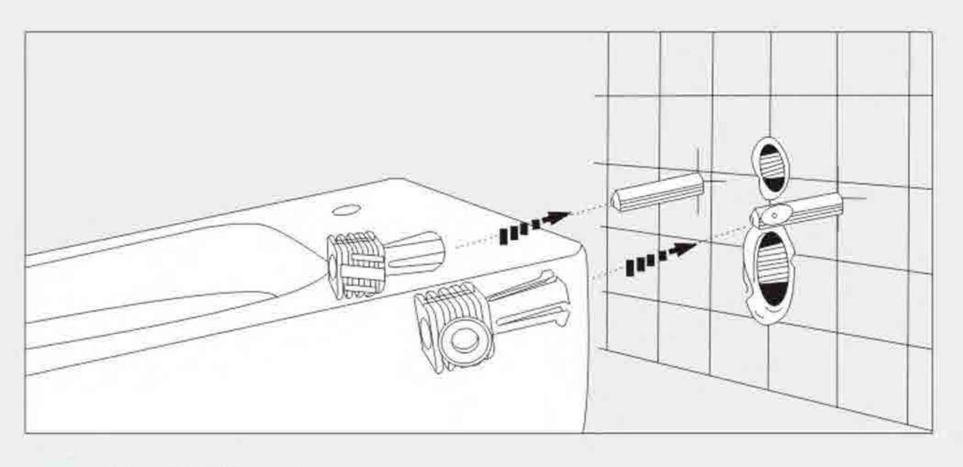
• 4. 将B套入C中。 Insert the Part C into Part B;
